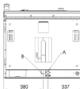
**A** Conexión 3/4" agua tratada      **B** Desagüe DN 40
